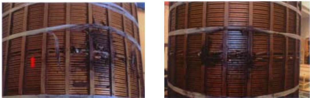
图 2 变压器绕组损坏的照片
